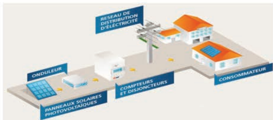
Figure 8. – Installation photovoltaïque raccordée au réseau électrique
